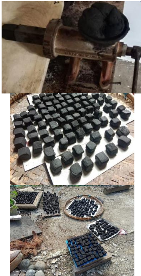
(a) (b) (c) Gambar 3. (a) Proses Pencetakan Briket, (b) Proses Penjemuran di Dalam Ruangan (c) Proses Penjemuran di Bawah Sinar Matahari
