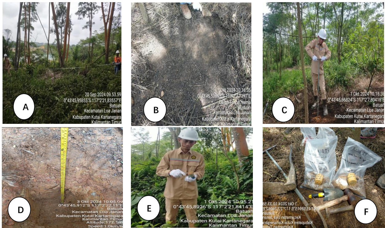
Gambar 2. Visualisasi pengambilan data (A) Pembuatan plot pengamatan, (B) Pembersihan area pengambilan sampel tanah, (C) Pemboran sampel tanah, (D) Pengukuran kedalaman pemboran tanah, (E) Pengambilan sampel dari pipa cincin, (F) Penyimpanan sampel tanah
