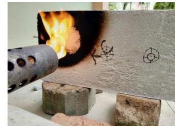
Gambar 3. Proses pembakaran pada titik bakar
