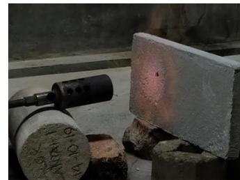
Gambar 2. Setting perletakan alat bakar dan panel
