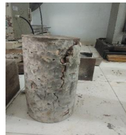
Gambar 4.2 Pola retak kerucut dan geser pada pengujian kuat tekan silinder beton dalam penelitian
