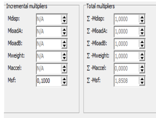
Gambar 7. Safety factor kondisi geometri dengan PVD jarak 1,2 m
