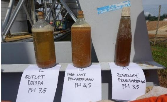
**Gambar 6.** Perbandingan air sampel sebelum dan setelah dicampurkan dengan bubuk kapur tanah
