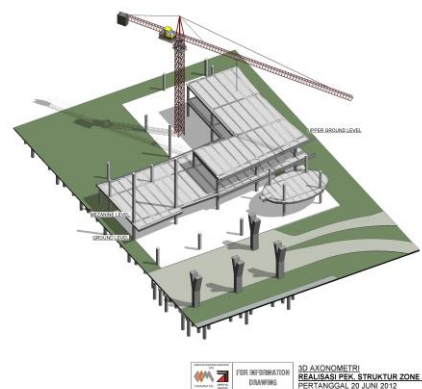
Gambar 4. Pelaksanaan Gedung Terminal Bandara Balikpapan zone 3 (Sumber; Dokumentasi Proyek Pengembangan Bandara Sepinggang /PPBIS Balikpapan)
