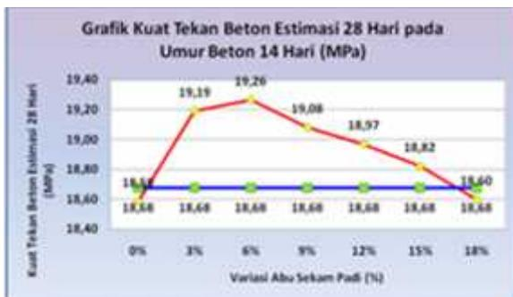
Dari hasil pengujian kuat tekan beton umur 14 hari (estimasi 28 hari) yang telah dilakukan, didapatkan hasil bahwa beton mengalami peningkatan dengan penambahan abu sekam padi pada variasi 3% dan 6%. Nilai kuat tekan maksimum terdapat pada benda uji dengan variasi penambahan abu sekam padi sebesar 6 %, yaitu dengan nilai sebesar 19,26 Mpa yang
