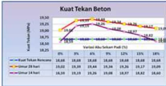
Penambahan abu sekam padi dapat meningkatkan kekuatan beton yaitu pada penambahan abu sekam padi sebesar 3% dan 6%, dimana didapatkan kadar optimum pada penambahan 6%. Pada umur 14 hari, beton mengalami peningkatan sebesar 3,10 % dari kuat tekan beton rencana. Sedangkan pada umur 28 hari, beton mengalami peningkatan sebesar 4,07 % dari kuat tekan beton rencana.
