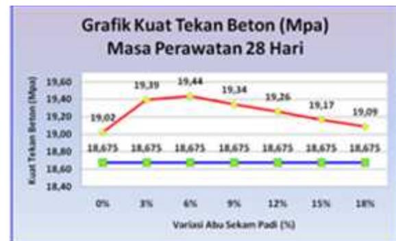
Dari hasil pengujian kuat tekan beton umur 28 hari yang telah dilakukan, didapatkan hasil bahwa beton mengalami peningkatan dengan penambahan abu sekam padi sebesar 3% dan 6%. Nilai kuat tekan maksimum terdapat pada benda uji dengan presentase variasi abu sekam padi sebesar 6 %, yaitu dengan nilai sebesar 19,44 Mpa yang mengalami peningkatan sebesar 4,07 % dari kuat tekan beton rencana.
