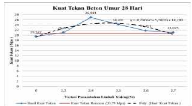
Gambar 4.4 Grafik perbandingan nilai kuat tekan beton dengan penambahan serat logam limbah kaleng umur 14 dan 28 hari
