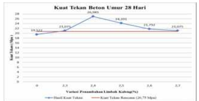
Gambar 4.3 Grafik nilai kuat tekan beton dengan penambahan serat logam limbah kaleng umur 28 hari
