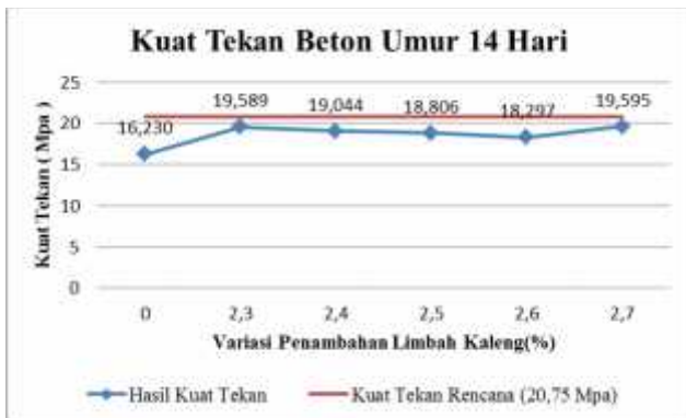
Gambar 4.2 Grafik nilai kuat tekan beton dengan penambahan serat logam limbah kaleeng umur 14 hari
