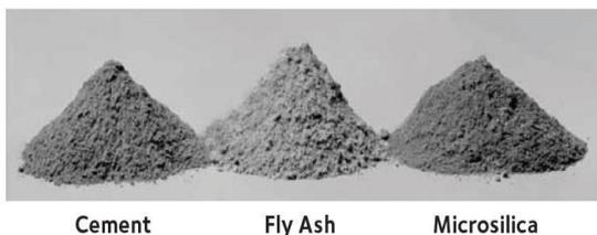
Gambar 4. Perbedaan semen, fly ash dan microsilica (silica fume)
