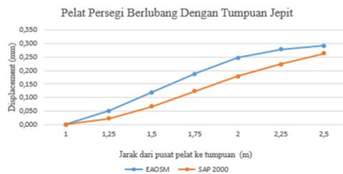
**Gambar 16** Perbandingan Hasil Analisa Lendutan Pada Pelat Persegi Berlubang Dengan Tumpuan Jepit Menggunakan Program EAoSM dan SAP 2000
