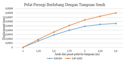
**Gambar 17** Perbandingan Hasil Analisa Lendutan Pada Pelat Persegi Berlubang Dengan Tumpuan Sendi Menggunakan Program EAoSM dan SAP 2000
