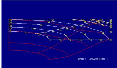
**Gambar 10** Hasil Analisa Displacement Pada Pelat Bentuk Persegi Dengan Tumpuan Jepit
