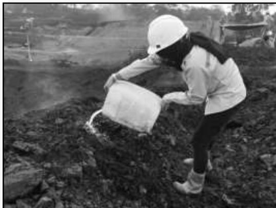
**Gambar 2.** Penyiraman Menggunakan Larutan Deterjen pada Titik yang Mengalami *Self Heating*
