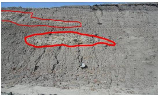
**Gambar 10.** Satuan litologi batulanau yang berselingan dengan *carbonaceous clay* dan sisipan batu pasir diantaranya.
