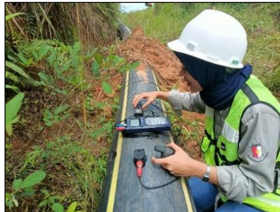
Gambar 3 Pemasangan Alat Ultrasonic Flowmeter untuk pengambilan Debit Aktual
