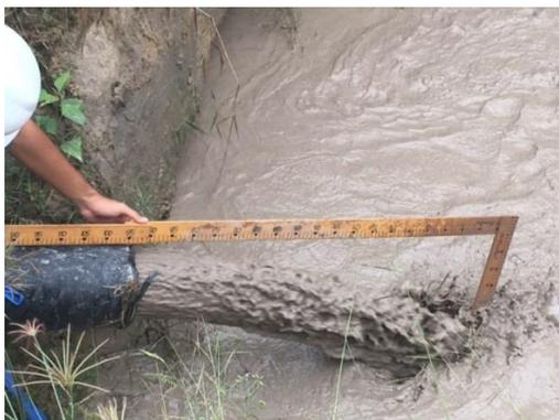
**Gambar 4.** Pengukuran debit aktual pompa *DND 150* menggunakan *flowbar*
