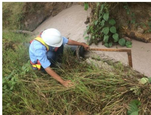
**Gambar 6.** Pengukuran debit aktual pompa *DND 100* menggunakan *flowbar*
