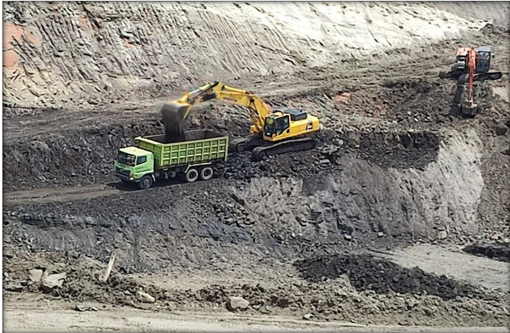
Kegiatan loading batubara dari excavator ke dump truck PIT utara
