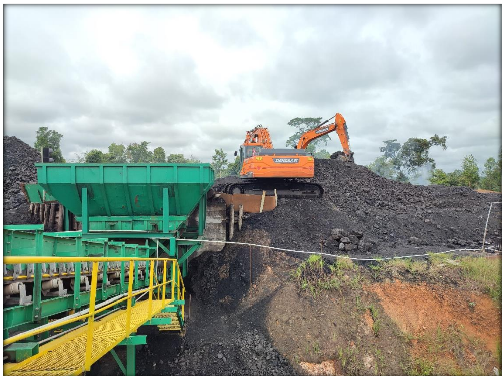
Kegiatan feeding yang dilakukan oleh 2 unit excavator Doosan DX300
