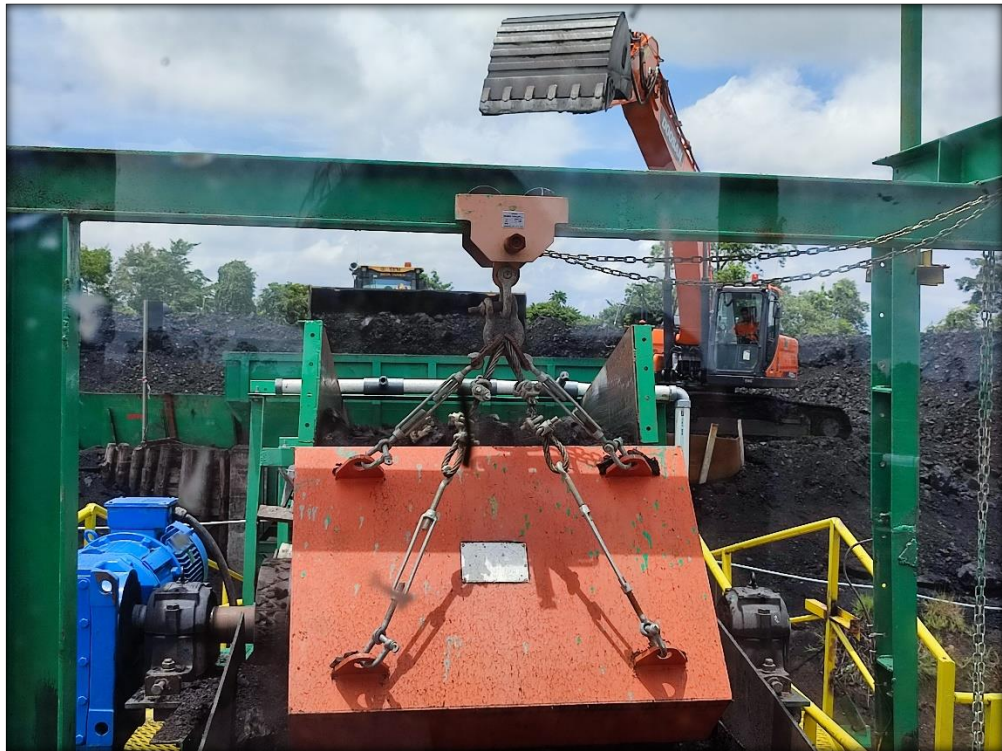
Kegiatan feeding dari excavator Doosan DX300 dan wheel loader SEM 660D
