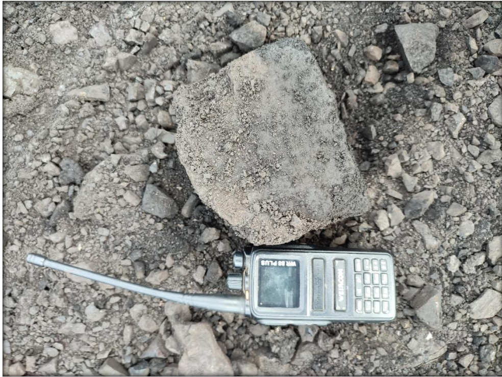
Produk akhir dari unit crushing plant dengan ukuran -100 mm
