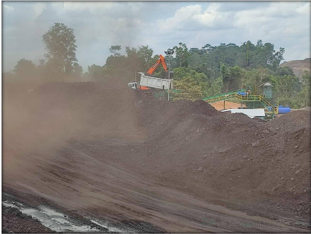
Kegiatan Direct dumping dari alat angkut coal getting PIT selatan di area ROM Stockpile
