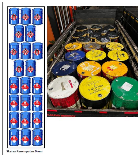
Gambar 2. Sketsa Penyusunan Limbah B3 Armada Truk Bak Terbuka
