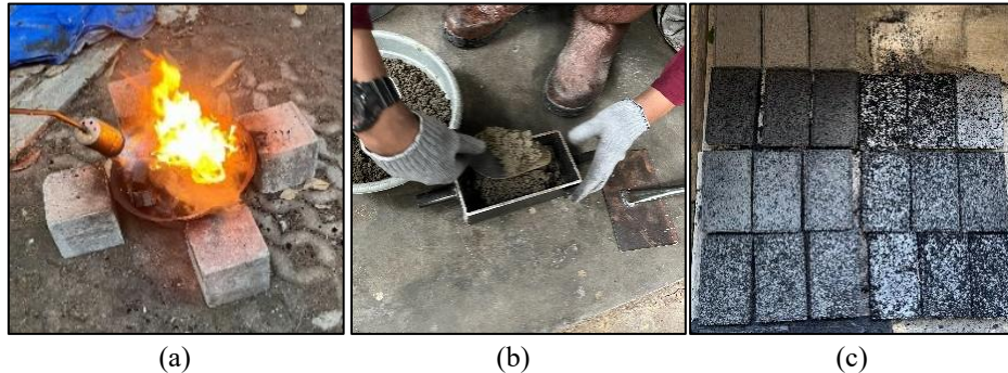
Gambar 3. (a) Pembakaran Limbah Ban, (b) Pencetakan Bata Beton, (c) Pengeringan Bata Beton
