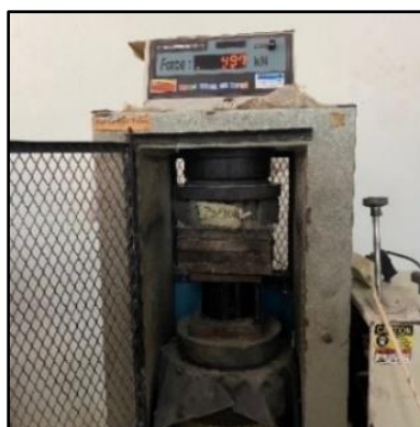
Gambar 2. Pengujian Kuat Tekan Bata Beton
