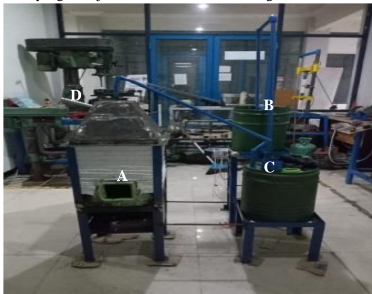
Gambar 1. Alat distilasi untuk proses pirolisis
