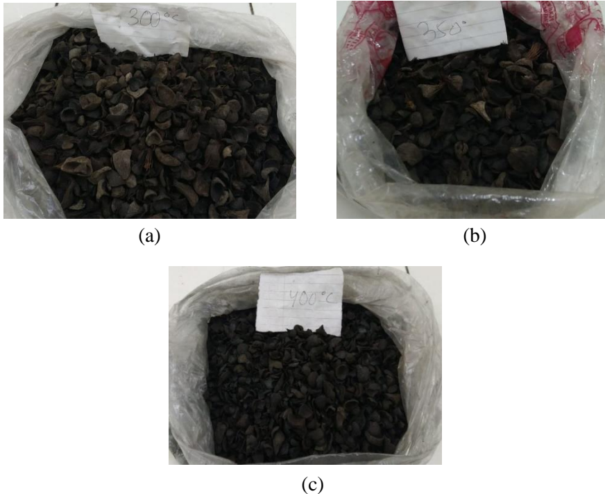
Gambar 6. (a) Bio-char dari cangkang kelapa sawit suhu 300°C, (b) bio-char dari cangkang kelapa sawit pada suhu 350°C, (c) bio-char dari cangkang kelapa sawit pada suhu 350°C
