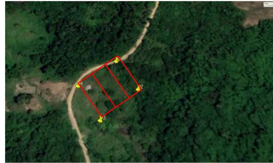
**Gambar 1.** Skema Lintasan *Geophone* untuk Akuisisi Seismik Refraksi *Mud volcano*
