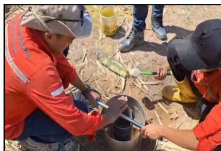
Gambar 4. Proses Pemasangan Alat Double Ring Infiltrometer
