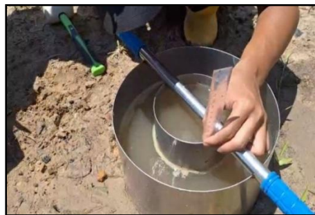
Gambar 6. Proses Pemasangan Penggaris Pada Alat Double Ring Infiltrrometer
