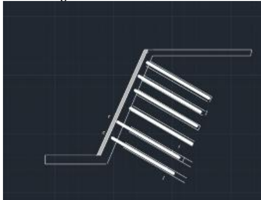
Gambar 4.24. Perencanaan Mitigasi Geoteknik Wiremesh dan Soil Nailing
