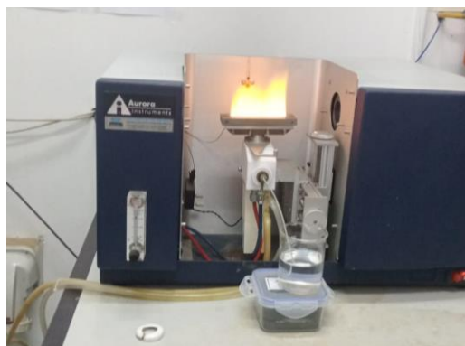
Gambar 3. Pengujian Sampel dengan Alat AAS ( Atomic absorption spectroscopy )
