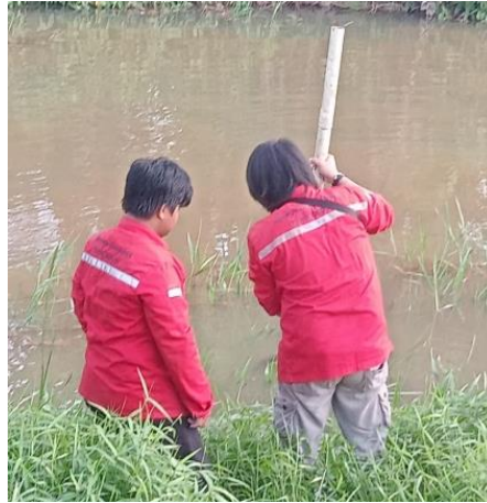
Gambar 1. Pengambilan Sampel dengan Pipa Coring
