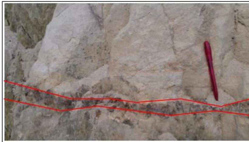
Gambar 6. Foto singkapan sisipan batulempung lokasi pengamatan 21
