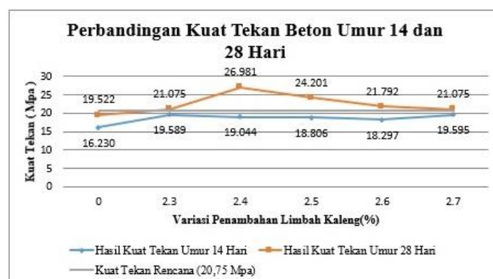
Gambar 4. Grafik Perbandingan Nilai Kuat Tekan Beton Dengan Penambahan Serat Kaleng Aluminium 14 Dan 28 Hari
