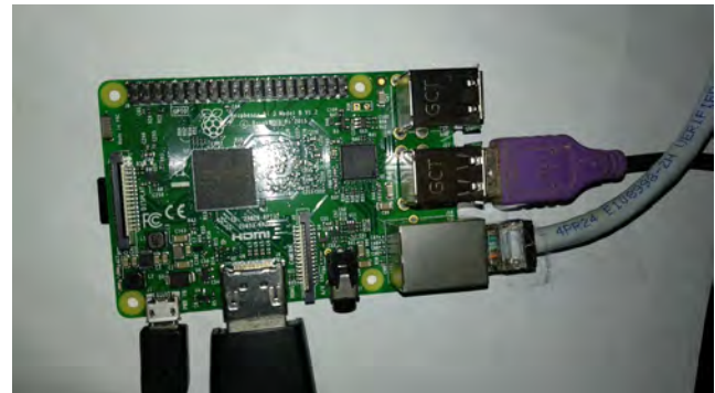
Gambar.2.Server VoIP pada RPi, didukung oleh mini-USB charger pin standar, HDMI monitor, Port Ethernet , USB keyboard dan mouse
