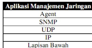
Gambar 1. Lapisan pada protokol SNMP
