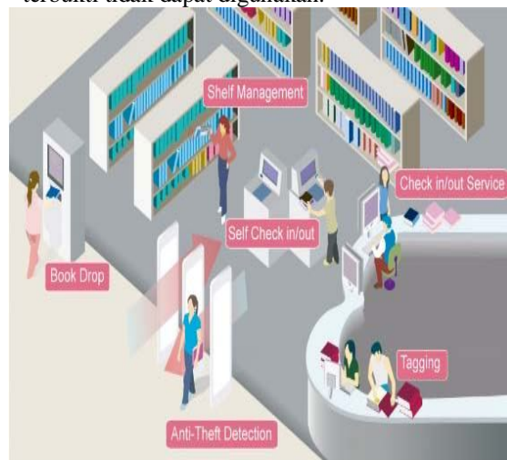
Gambar 3.1. Implementasi RFID untuk Perpustakaan
