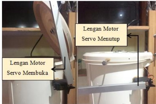
Gambar 13. Pengaturan Sudut Lengan Servo Membuka dan Menutup, tutup terbuka (a), tutup tertutup (b)
