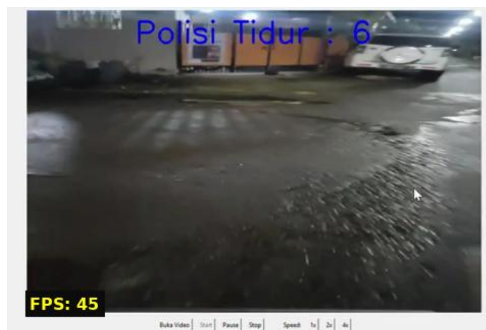
Gambar 5. Contoh hasil deteksi dan counting speed bump pada video lapangan
