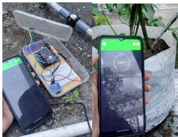
Gambar 3. Prototipe alat untuk mengukur kecepatan aliran air irigasi
